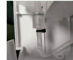
3. Hidrogel líquido sin o con poca viscosidad: quitar la válvula conectada en la parte inferior de la botella y cambiar por la de la imagen.
